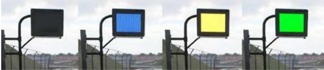
El **Circuito de Navarra** dispone de **21 Leds Panels** distribuidos principalmente en las zonas de entrada y salida de las diecisiete curvas del trazado, al que se une un **“Info Panel”** ubicado en el pórtico de salida, desde donde se difunden posibles sanciones y la distancia de carrera pendiente.
