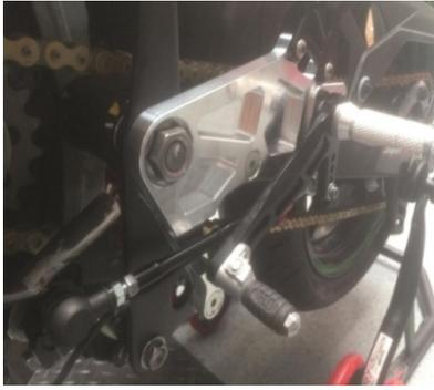
Las placas laterales del chasis, donde van cogidos los soportes de las estribas, DEBEN ser las originales. El soporte de la estribera izquierda puede usar un punto adicional de sujeción sobre la placa, pero solo UNO más.
