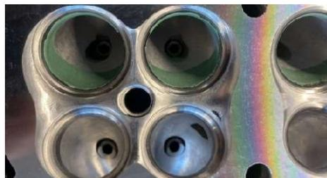
En la culata (GYTR 008E11110000) se puede añadir material epoxídico (no se permite soldar) justo en los primeros 15 mm bajo el asiento de la válvula de ambos puertos de admisión y escape para suavizar la transición puerto-asiento. No se permite ninguna otra modificación en esta culata.
